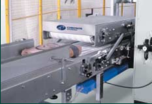
Sackpressvorrichtung als Bügelband mit Dämpfungseinrichtung
