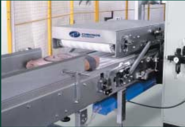
Sistema di pressatura con doppio nastro a compensazione pneumatica
