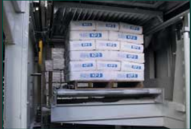
La stabilità della paletta è aumentata grazie alla compressione degli strati
